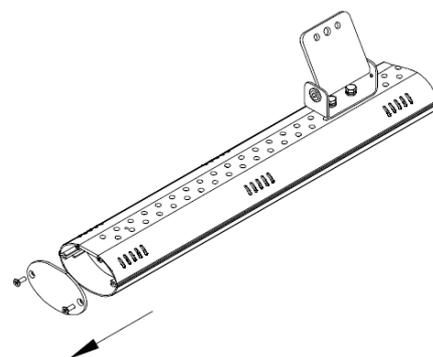
2. Åpne kapslingen ved å dreie det i retningen vist på tegningen, og løsne koblingen på venstre side av varmelampen, trekk kablen fra hverandre (NB! Trykk på sperrelåsen når du trekker kablene bort fra hverandre).
