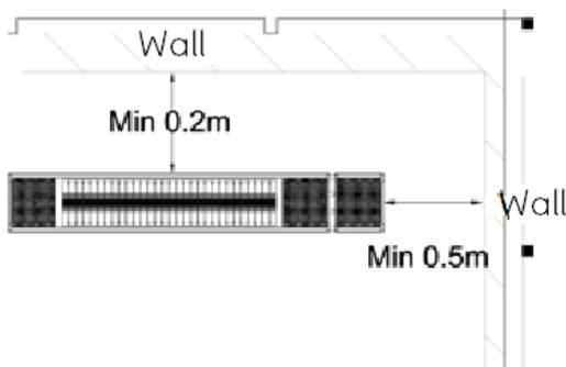
**OBS! Minimumsavstand til vegg/tak som terrassevarmeren er festet til, er gitt av lengden på medfølgende brakett.**
