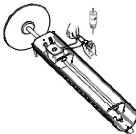
4. Løsne låsen på varmelampen på begge sider. Fjern varmelampen.
