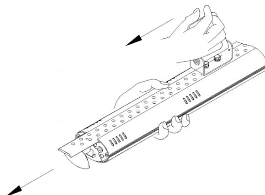
4. Åpne kapslingen som vist på tegning 2. Løsne tilkoblingen på høyre side av varmelampen, og trekk kablen fra hverandre (NB! Trykk på sperrelåsen når du trekker kablene bort fra hverandre).
