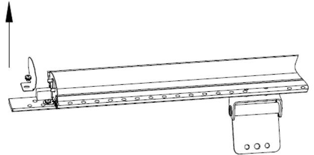
7. Løsne låsen på varmelampen på begge sider. Fjern varmelampen og sett inn den nye. Fest låsene på begge sider av varmelampen. NB! Ikke berør varmelampen med bare fingre. Hvis varmelampen har blitt berørt ved et uhell, må eventuelle fingeravtrykk tørkes av med en myk klut fuktet med rødsprit, fingeravtrykkene etterlater fett som kan brenne på varmelampen. Dette forkorter varmeapparatets levetid.
