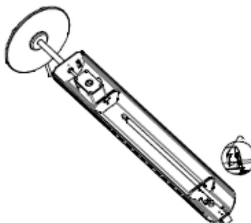
5. Sett inn den nye varmelampen. NB! Ikke berør varmelampen med bare fingre. Hvis du har berørt varmelampen i forbindelse med en feil, må eventuelle fingeravtrykk tørkes av med en myk klut fuktet med rødsprit. Fingeravtrykkene etterlater fett som kan brenne på varmelampen. Dette forkorter varmerørets levetid.
