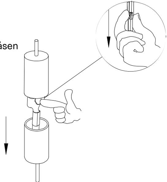
5. Ta ut varmerøret og sett inn det nye. NB! Ikke berør varmerøret med bare fingrene. Hvis varmerøret berøres ved en feil, skal fingeravtrykk vaskes bort med en myk klut fuktet med rødsprit. Fingeravtrykkene etterlater seg fett som kan brenne seg fast. Dette forkorter varmerens levetid
